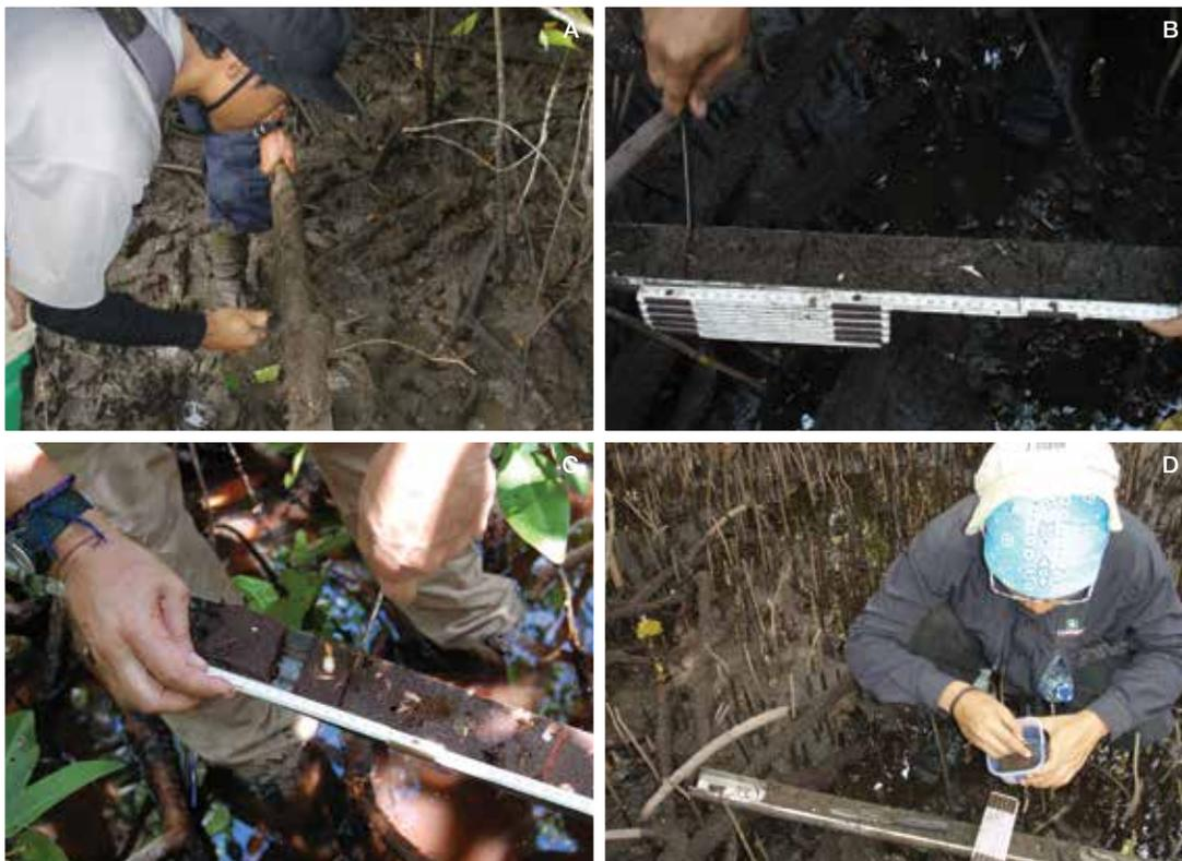
Figura 3.15 Recolección de muestras de suelo con una barra de cara abierta. (A) Remoción de suelo de la cara de la barra. (B) Medición y marcación de los intervalos de profundidad. (C) Corte de una muestra. (D) Extracción de la muestra de la barra y colocación en un recipiente numerado. (© Boone Kauffman, OSU)
