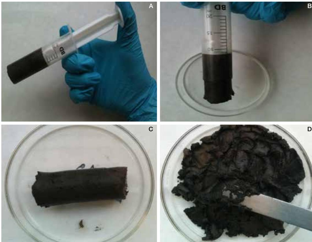
**Figura 3.17** Extracción de muestra de la jeringa y preparación para secado en horno. (A) Muestra en la jeringa. (B) Colocación de la muestra en una placa de Petri pesada previamente. (C) Muestra recién extraída de la jeringa. (D) Esparciendo la muestra con una espátula. (© Hilary Kennedy, UWB)
