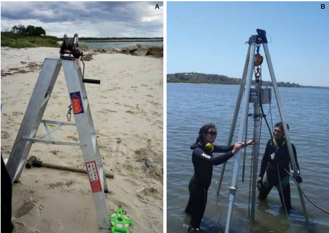
Figura 3.8 Preparación de equipos para obtener núcleos en ecosistemas de pastos marinos. Instrumentos para la obtención de núcleos en suelos de pastos marinos: (A) escalera con manija para extraer el nucleador de suelo blando en aguas poco profundas (© Sarah Hoyt, CI); (B) trípode robusto con sistema de polea para extraer el nucleador de suelo blando en aguas profundas o poco profundas (© Óscar Serrano, ECU)
