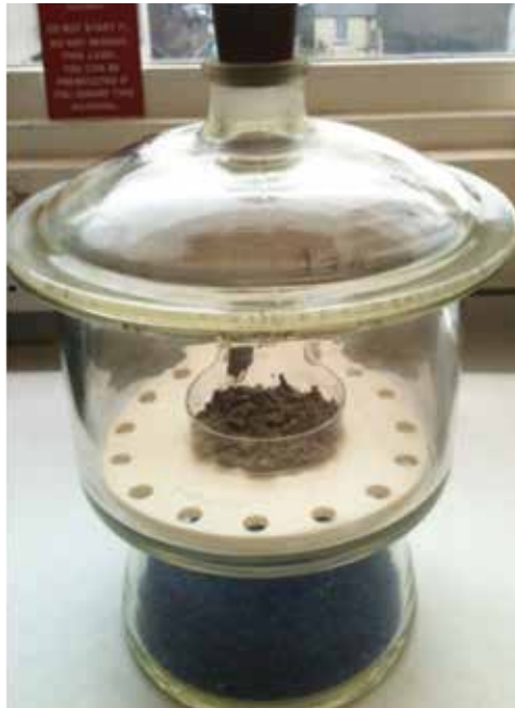
Figura 3.18 Muestra de suelo enfriándose a temperatura ambiente en un desecador (© Hilary Kennedy, UWB)
