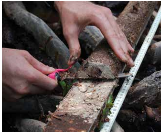
Figura 3.10 El tubo de revestimiento se ha cortado longitudinalmente para dejar expuesto el suelo para el archivo y la toma de submuestras. Este núcleo está en proceso de dividirse. Una cara limpia queda expuesta en la parte inferior de la imagen. (© Boone Kauffman, OSU)
